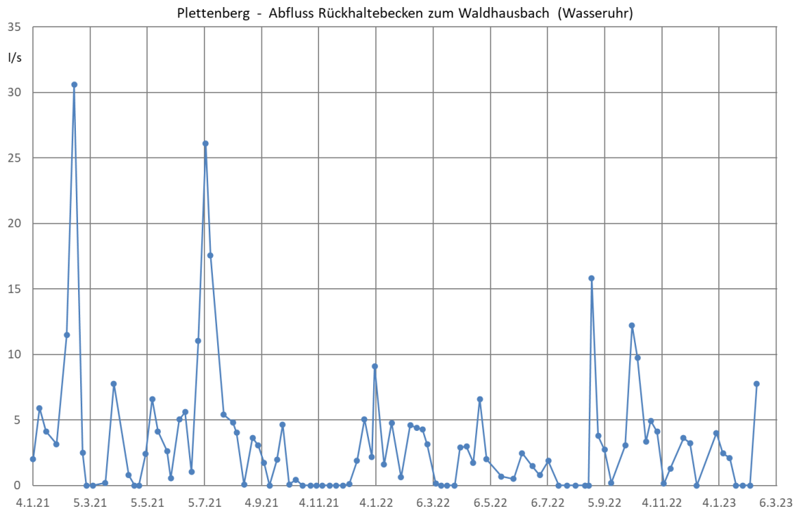
Abb. 5-3: Abfluss aus dem Becken-Außen über die Rohrleitung zum Waldhausbach
