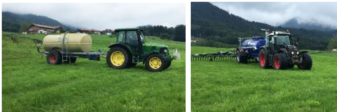
Abb. 18: Durch eine Ausbringung bei bedecktem Himmel, kühlem, feuchten und windstillem Wetter lassen sich Ammoniakverluste stark senken – aber auch bei idealem „Gülewetter“ sind die Emissionen bei bodennaher streifenförmiger Technik (Bild rechts) niedriger als bei Breitverteilung (Bild links)
