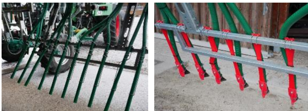
Abb. 3: Unterschied zwischen Schleppschlauchtechnik (links) und Schleppschuhtechnik (rechts, hier dargestellt für die Gülleausbringung im Versuchswesen. Schleppschuhe wurden insbesondere für die Ausbringung auf Grünland entwickelt.
