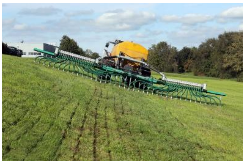
Abb. 12: Gerade in Hanglagen werden erhöhte Anforderungen an die Technik gestellt, um die Gülle sauber an den Boden zu bekommen.
