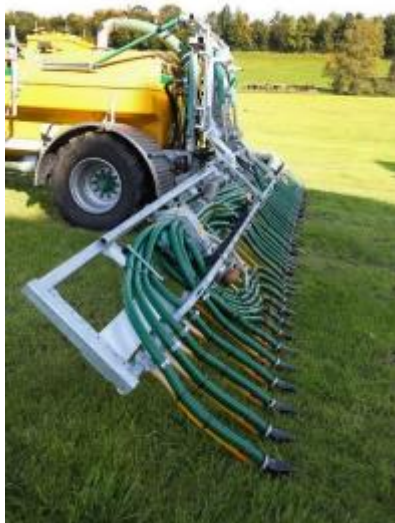
Abb. 7: Die Abstimmung von erzielbarem Auflagedruck der Kufen sowie die Ausformung der Kufen selbst spielen für die Vermeidung von Futtermittelschmutzungen eine wichtige Rolle.
